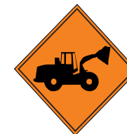
Equipo Pesado en la Vía T 7
