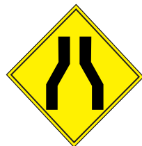
Estrechamiento (En las dos manos) P 10
