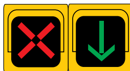
Semáforos especiales para carriles reversibles
