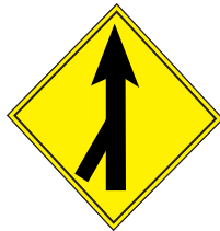
Incorporación de Tránsito Lateral P 22
