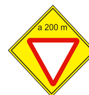
Proximidad de Señal Restrictiva (Paso) P 33
